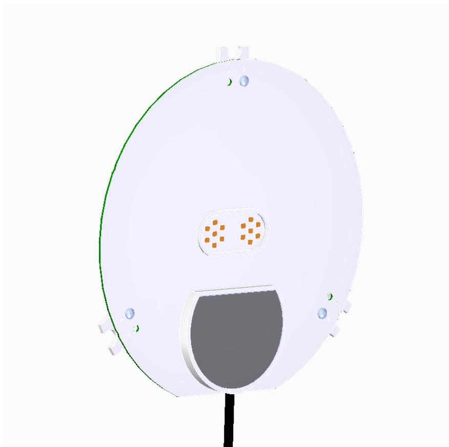
*Vue 7-2 PCB avec électronique et LED*
