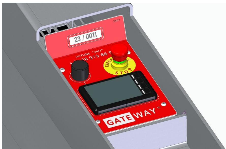
Figure 9-1 Interface de commande
